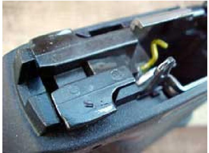
El sistema de seguridad se complementa con un disparador de dos secciones como el de la Sigma y similar al de Walter P99, que bloquea el desplazamiento de la barra del disparador hasta que no tenga el dedo del tirador presionando el disparador.
