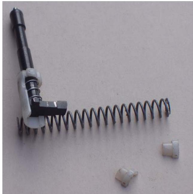
El sistema de percusión por aguja lanzada es de similar factura al de las Glock/SIGMA/P99, con un sistema de seguro automático de aguja que sujeta a esta por la parte trasera derecha, donde no hay soporte del porta percutor sintético.
